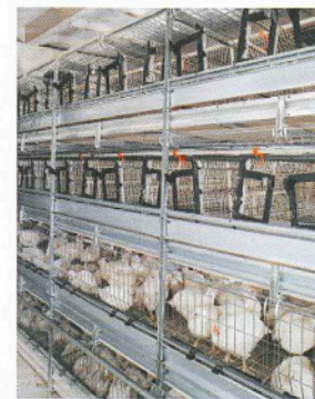
Благодаря запатентованной инновационной технологии наклоняющегося пола Avimax позволяет значительно легче выдворить птицу. На фотографии птица из верхнего яруса уже выдворена.
